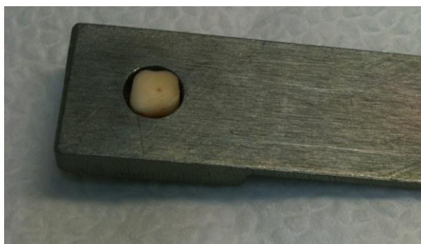
Рисунок 2.14 – Распиленный зуб, зафиксированный в металлической пластине
