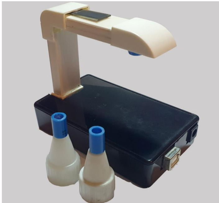
Рисунок 2.7 – Прибор для измерения температуры кристаллизации
