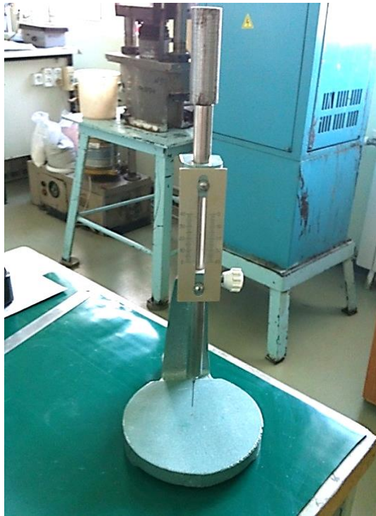
Рисунок 2.4 – Индентор массой 400 \pm 5 г с плоским концом диаметром 1,0 \pm 0,1 мм.
