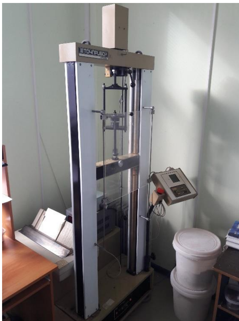
Рисунок 2.10 – Разрывная машина ИР5040
