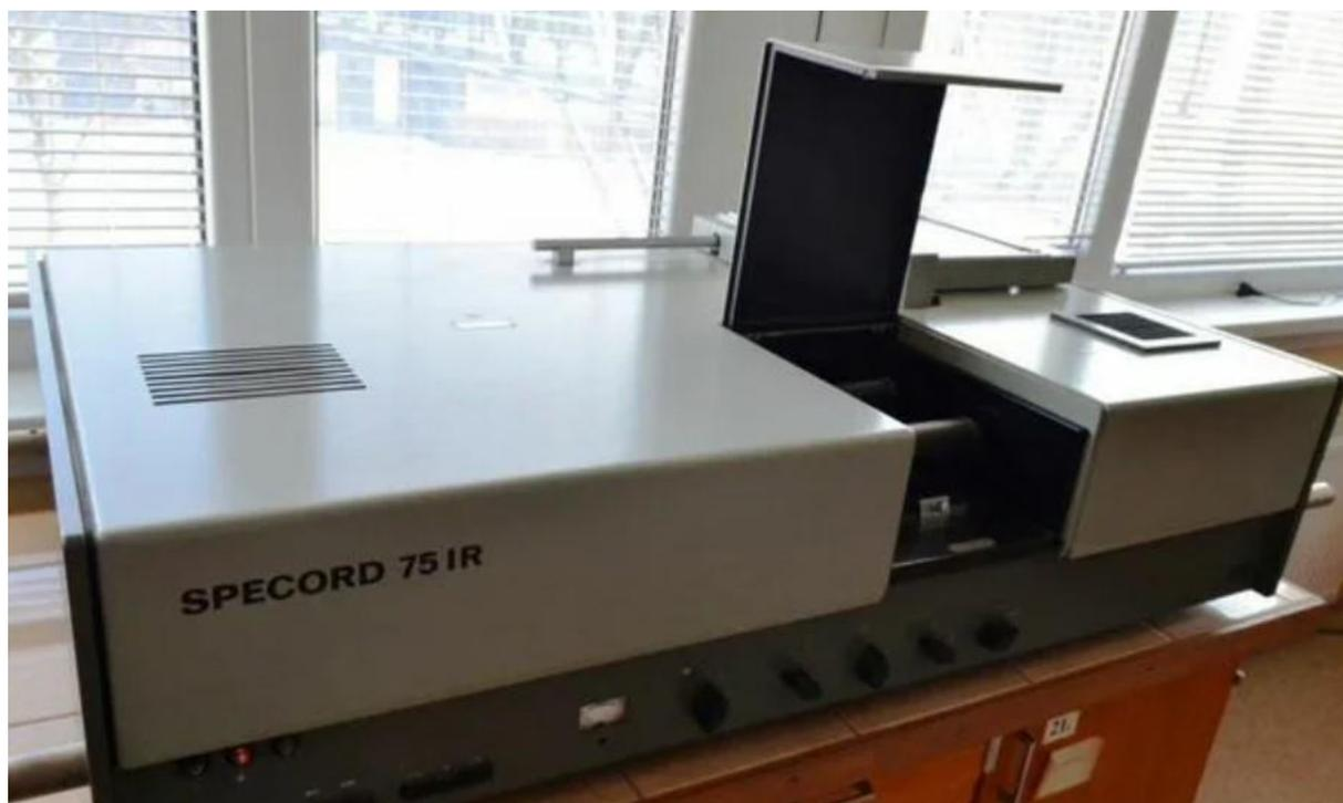
Рисунок 13 – Спектрофотометр «Carl Zeiss Jena SPECORD IR-75» (Германия)
