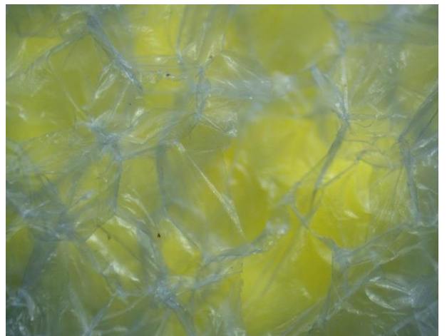
Рисунок 30 (продолжение) – Микрофотография. Результат световой микроскопии исследуемых образцов: Д – губка коллагеновая гемостатическая, Е – средство кровоостанавливающее «Surgicel Fibrillar», Ж – «рабочая сторона» пластины кровоостанавливающей «Тахокомб», З – ее обратная сторона (коллагеновая нетканая основа). Ув. x10
