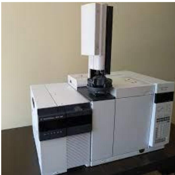
Рисунок 2.6 – Хроматограф Agilent 7890B GC System с масс-селективным детектором Agilent 5977A MSD (Agilent Technologies, USA)
