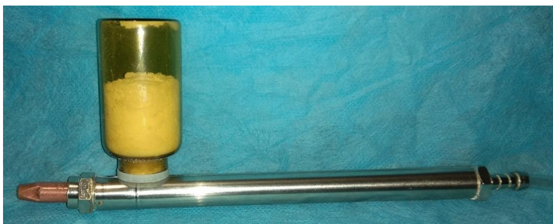
Рисунок 3 – Внешний вид распыляющей части устройства для проведения струйной кислородо-сорбционной обработки ран
