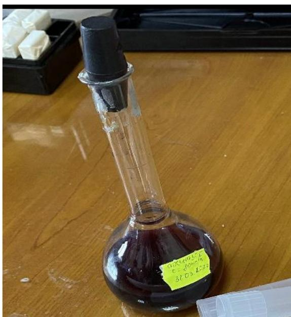
Рисунок 2.10 – Для проведения фотометрирования был использован индикатор Арсенazo III
