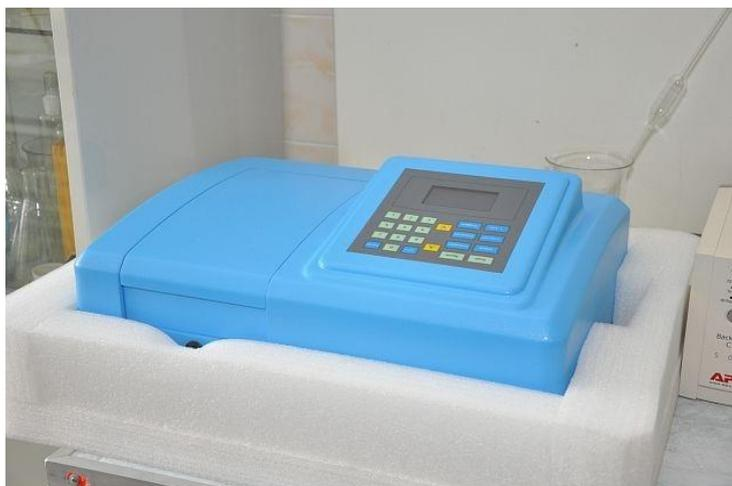
Рисунок 2.11 – Спектрофотометр КФК-ЗКМ (Россия), который был использован для измерения коэффициентов оптической плотности и концентрации исследуемых растворов
