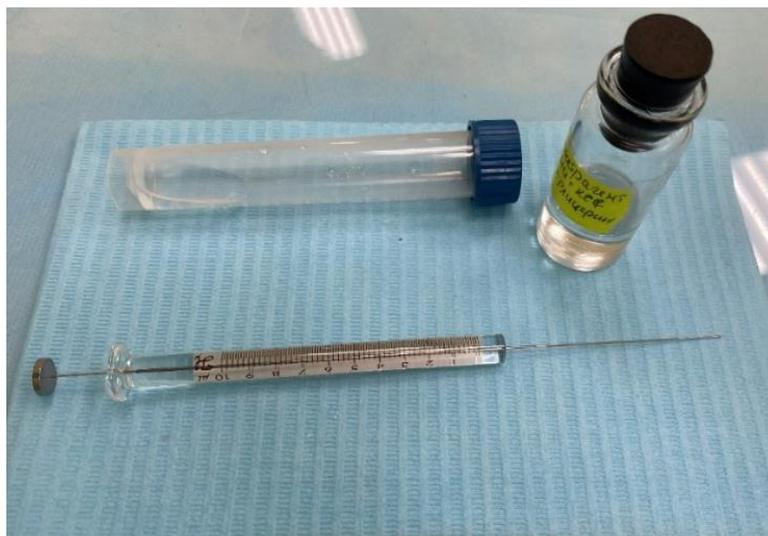
Рисунок 2.8 – Микро-шприц, который был применен для нанесения на поверхность исследуемого зуба капли деминерализующей жидкости
