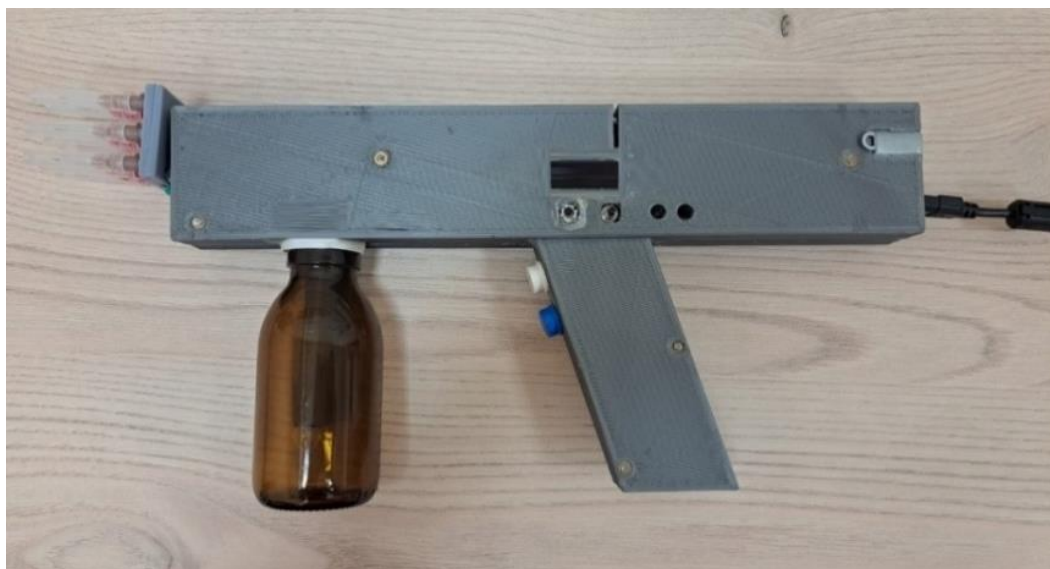
Рисунок 2 – Устройство для инъекционного введения лекарственных препаратов с насадкой для выполнения внутривенных инъекций
