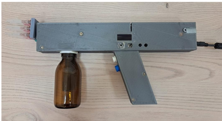
Рисунок 7 – Внешний вид устройства для инъекционного введения лекарственных препаратов с насадкой (патент RU 213859 U1 от 30.09.2022)
