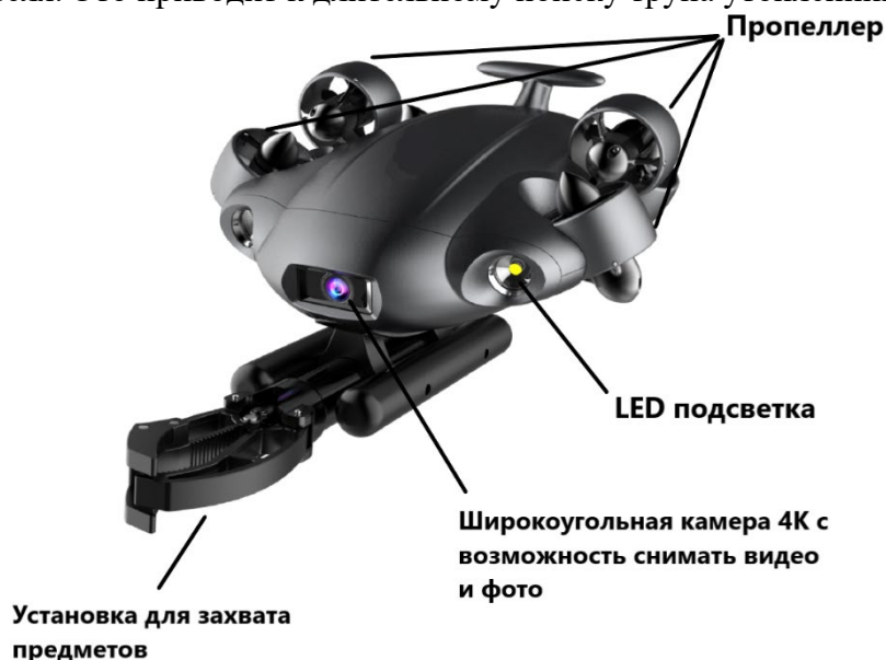
Рисунок 1. Беспилотный подводный аппарат. Внешнее строение.
