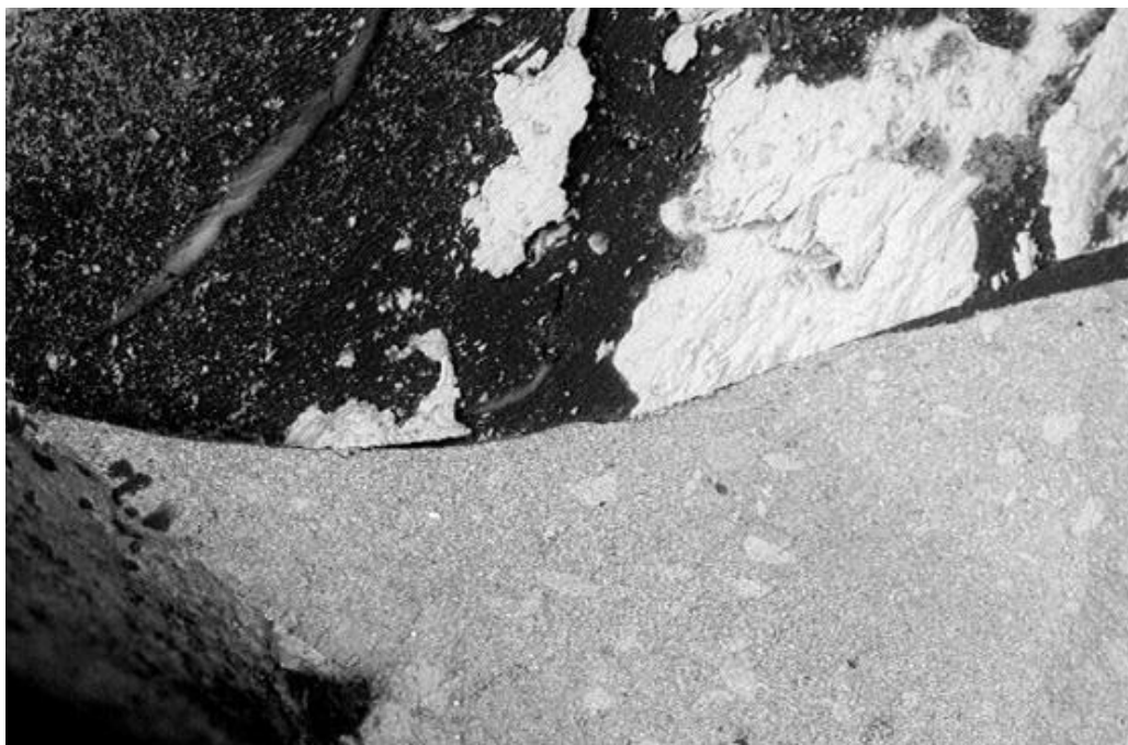
Рисунок 3.7 - РЭМ «адгезивного слоя» на поверхности эмали (группа №2, адгезив с этанолом)
