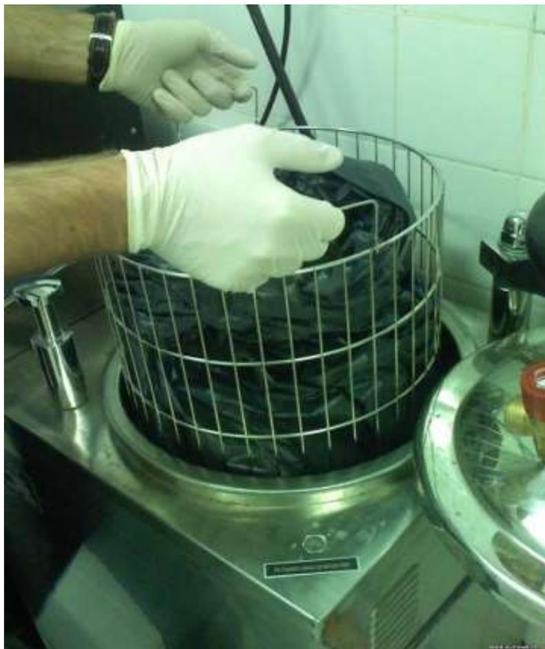
достаёт корзину из автоклава и ставит ее на пол. Выстилает корзину полипропиленовым мешком для автоклавирования и складывает внутрь принесенные из отделений пакеты с отходами. Далее всё перфорирует в нескольких местах для эффективного поступления пара внутрь отходов и устанавливает корзину в автоклав.
