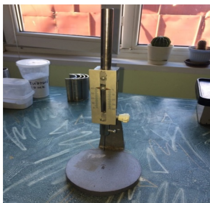
Рисунок 33 – Внешний вид индентора с иглой типа Жилмор
