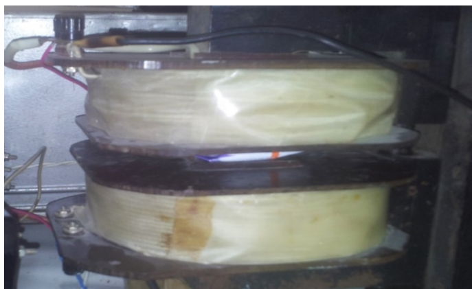
Рисунок 17 – Внешний вид устройства для намагничивания с образцами силера перед началом процесса обработки материала электромагнитным полем
