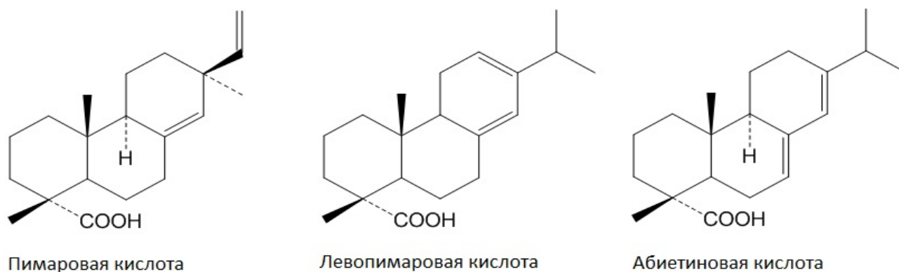
Рисунок 4 – Химические формулы некоторых циклических смоляных кислот, содержащихся в канифоли
