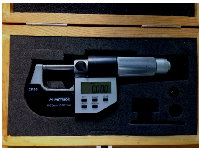
Рисунок 36 – Микрометр Metrika IP54 с погрешностью не более 1 мкм
