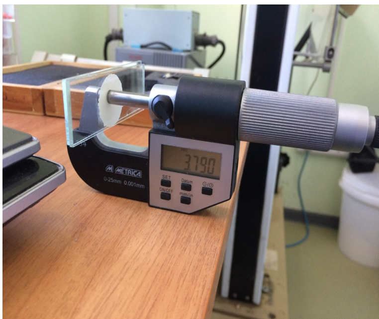
Рисунок 39 – Исследования толщины пленки силера между двух стеклянных пластин при помощи микрометра
