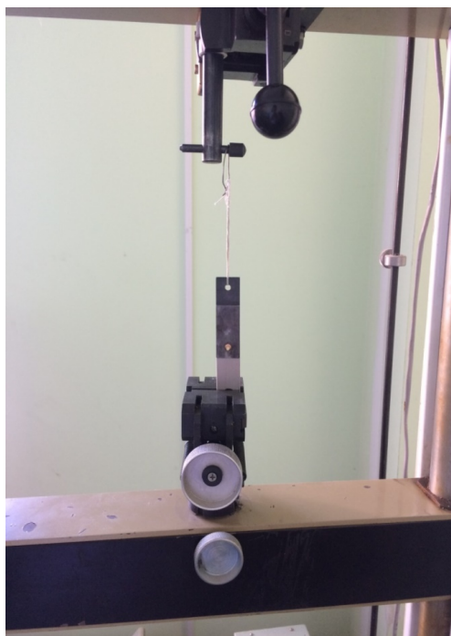
Рисунок 29 – Фиксация образца в испытательной машине
