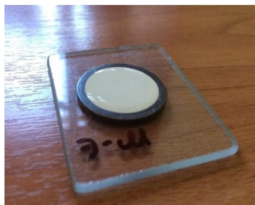
Рисунок 34 – Металлическая форма с исследуемым силером на стеклянной пластине
