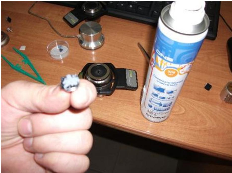
**Рисунок 16.** Обработка исследуемого материала сжатым воздухом
