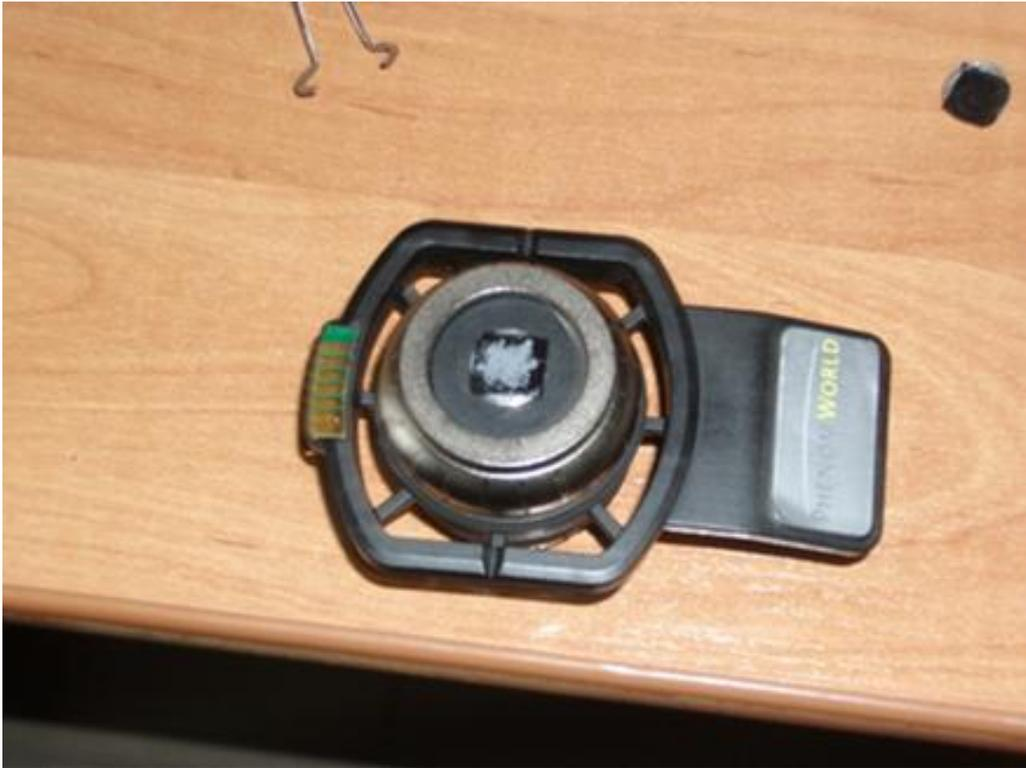
**Рисунок 17.** Подложка для исследования образца под растровым электронным микроскопом
