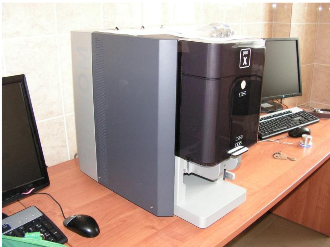
**Рисунок 14.** Растровый электронный микроскоп
