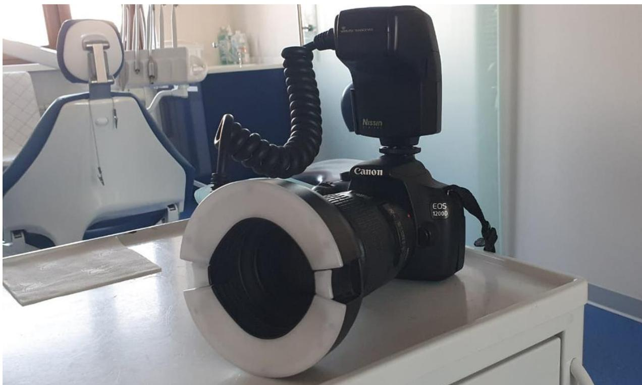
Рисунок 9 – Фотоаппарат «Canon EOS 1200D», оснащенный объективом «Canon Macro lens EF 1:2,8 USM» и вспышкой кольцевой «Nissin Digital MF18 Macro Flash» для фотодокументирования и диагностического фотографирования зубных рядов
